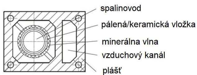
Obrázok 1.1.5 – Všeobecné nákresy rezu pre použitie koncentrických komínov s prívodom vzduchu a vedľa seba komínov s prívodom vzduchu (príklady)
