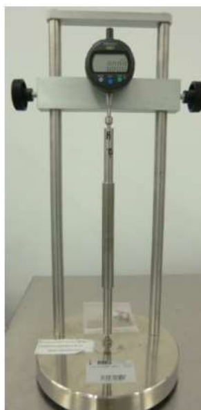
Obrázok D.2.1 – Zariadenie na meranie zmeny rozmerov, horné a dolné kontaktné prvky, guľôčková a štandardná tyč
