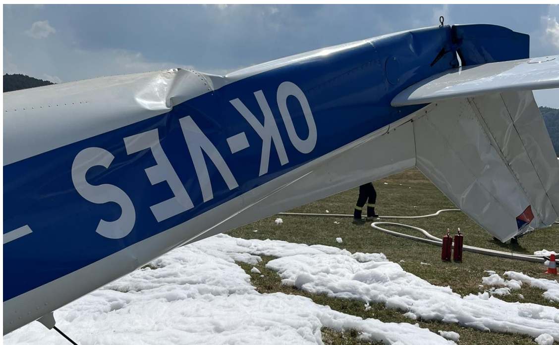
Obr. č. 12 poškodenie trupu
